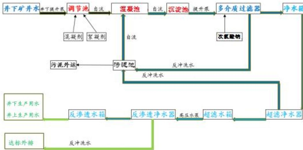
图 2-2 矿井水处理工艺流程图
